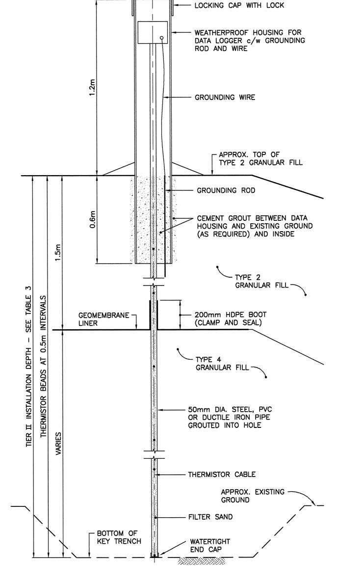
GROUND TEMPERATURE CABLE INSTALLATION - TIER II N.T.S.
