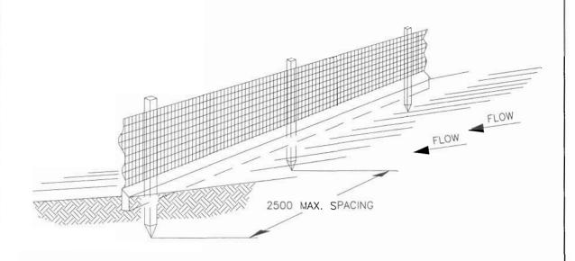
NOTE: SILT FENCE SHALL BE PLACED ON SLOPE CONTOURS TO MAXIMIZE PONDING EFFICIENCY
