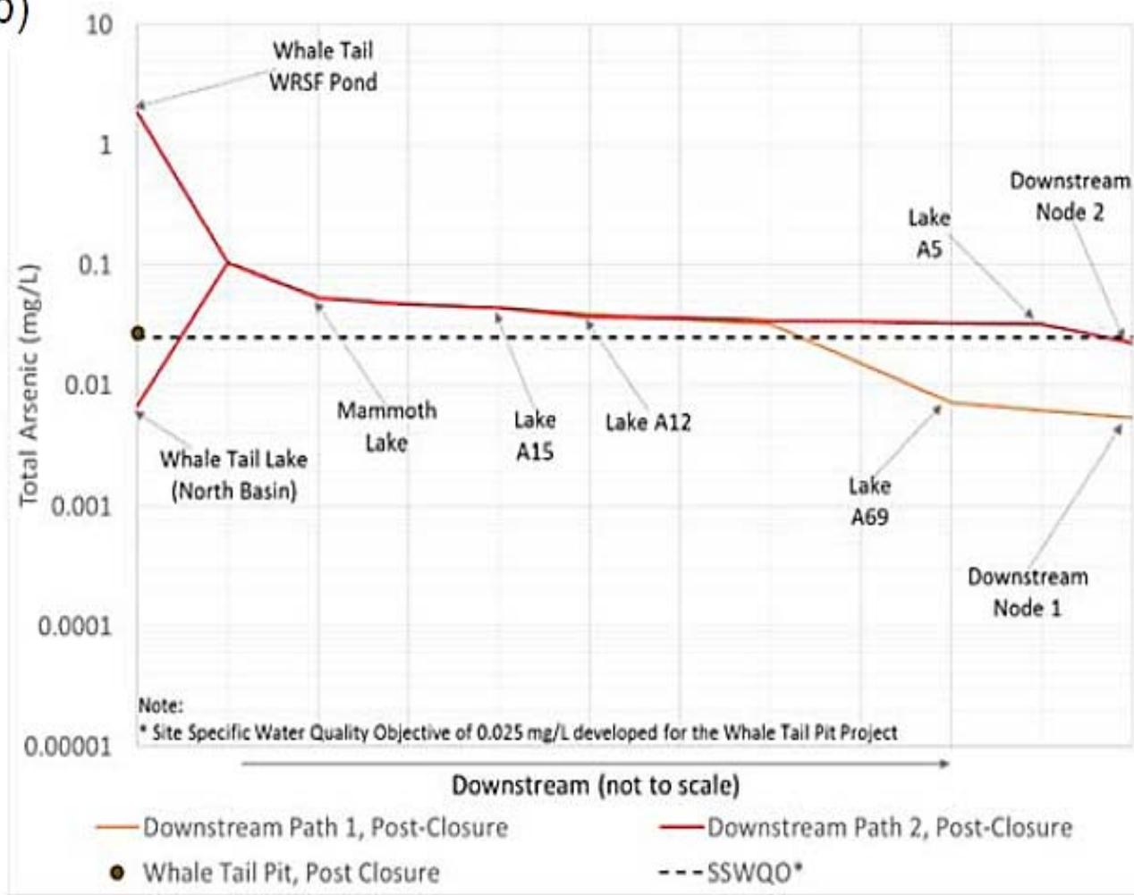
Qualité de l'eau en aval avec une profondeur active de dégel à 4 m (sans traitement) si le recouvrement de l'ISS comprend 2 % de matériaux favorisant la lixiviation de l'arsenic.
