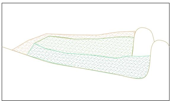
SITE CLOSURE WILL CONSIST OF 600mm OF THE MOST IMPERMEABLE COVER SOIL LOCALLY AVALIBLE. MAXIMUM SLOPE 3:1. THE SURFACE CAN BE STABILIZED WITH COBBLES AND ROCK TO RESEMBLE THE APPERANCE AND CONDITION OF THE SURROUNDING TUNDRA.
